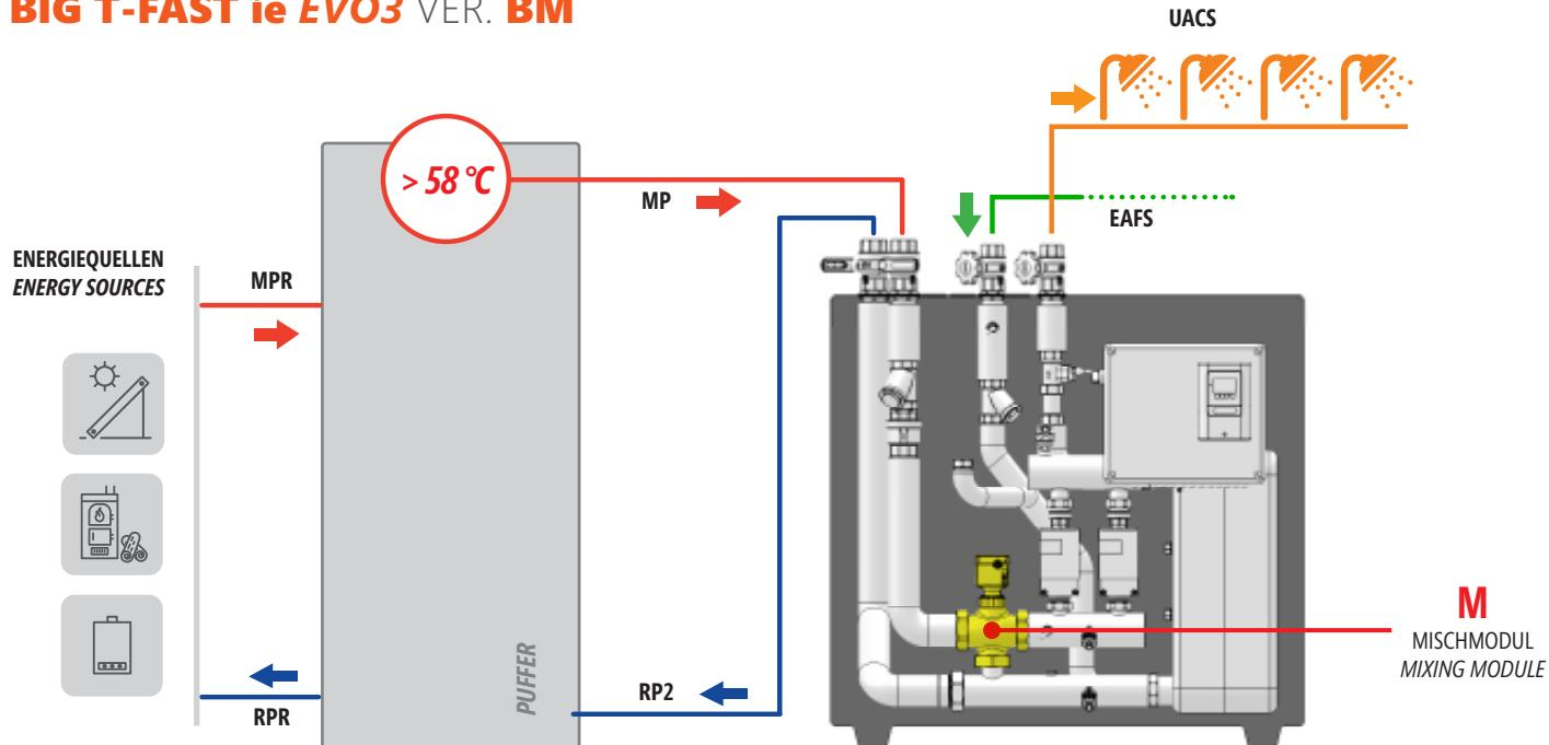
Die **BM**-Version wird für die Warmwasserbereitung mit technischem Wasserspeicher bei einer Temperatur von mehr als 58°C empfohlen, z.B. durch Biomasseerzeugern, Kesseln, Elektroheizungen, Blockheizkraftwerken, Fernheizkraftwerken usw.
