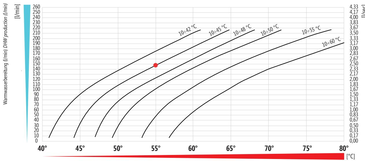
**Hinweis:** Die einwandfreie Funktion des Moduls ist gewährleistet, wenn die Vorlauftemperatur im Primärkreis mindestens 3°C über der eingestellten Warmwassertemperatur liegt
