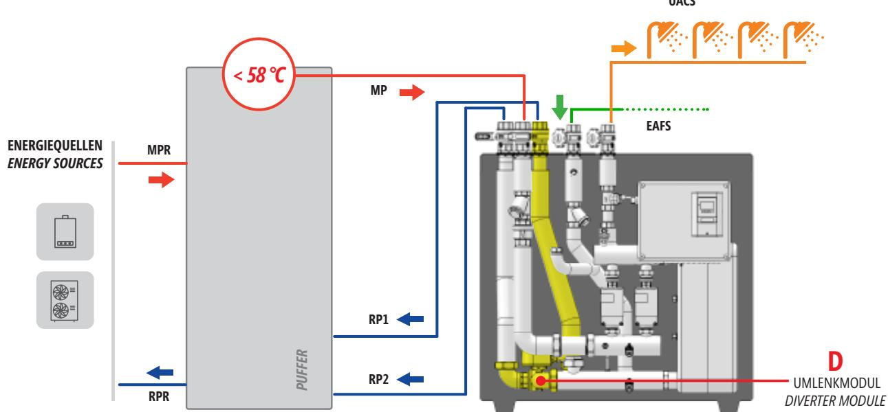
Die **BD** wird für die Warmwasserbereitung mit technischem Wasserspeicher bei einer Temperatur unter 58°C empfohlen, z.B. durch Wärmepumpen und Brennwertkessel.
