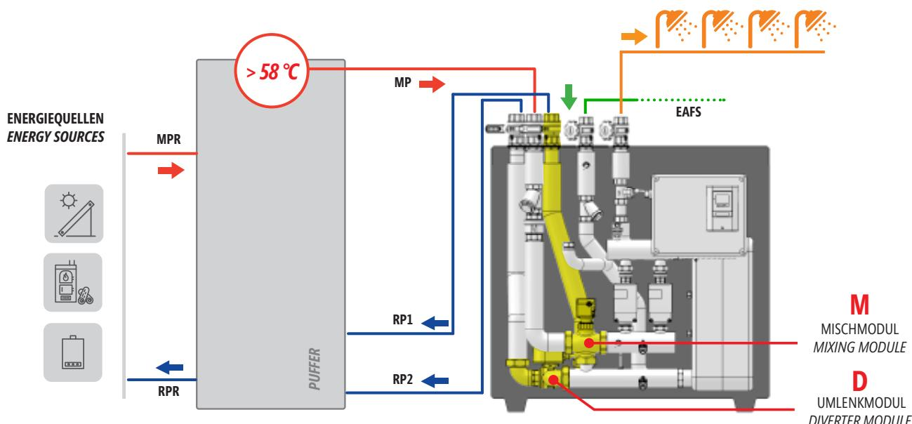
Die **BMD**-Version wird für die Warmwasserbereitung mit technischem Wasserspeicher bei einer Temperatur von mehr als 58°C empfohlen, z.B. durch Biomasseerzeugern, Kesseln, Elektroheizungen, Blockheizkraftwerken, Fernheizkraftwerken usw.
