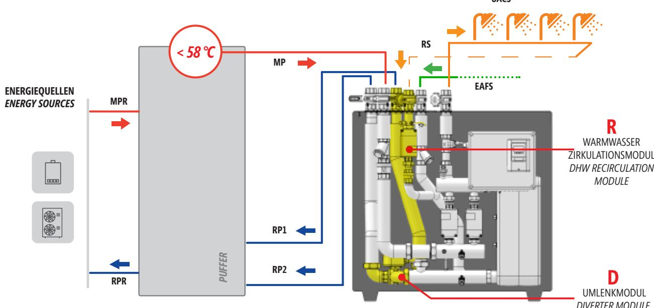
Die **BDR**-Version wird für die Warmwasserbereitung mit technischem Wasserspeicher bei einer Temperatur unter 58°C empfohlen, z.B. durch Wärmepumpen und Brennwertkessel.
