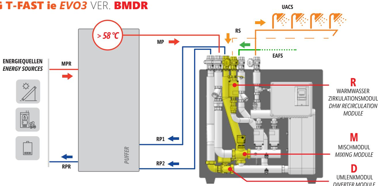
Die **BMDR**-Version wird für die Warmwasserbereitung mit technischem Wasserspeicher bei einer Temperatur von mehr als 58°C empfohlen, z.B. durch Biomasseerzeugern, Kesseln, Elektroheizungen, Blockheizkraftwerken, Fernheizkraftwerken usw.
