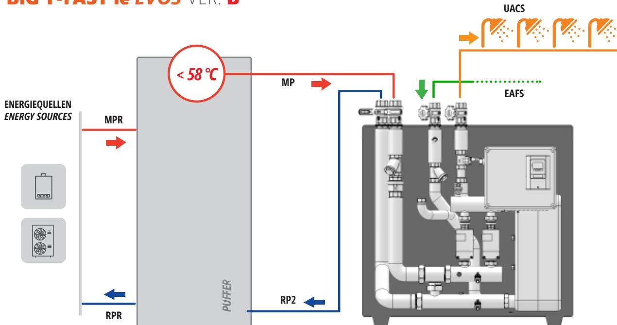
Die **B**-Version wird für die Warmwasserbereitung mit technischem Wasserspeicher bei einer Temperatur unter 58°C empfohlen, z.B. durch Wärmepumpen und Brennwertkessel.
