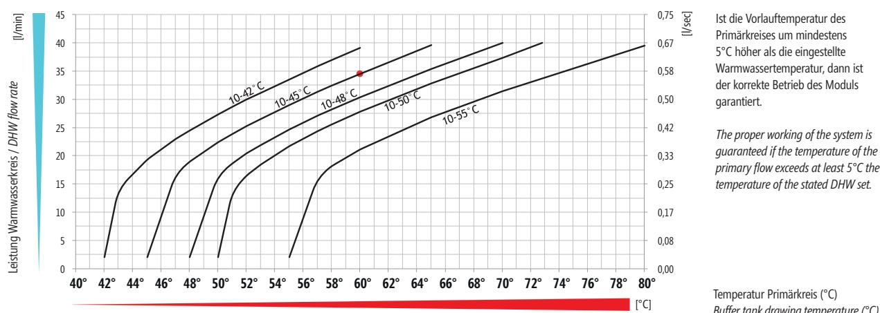
Ist die Vorlauftemperatur des Primärkreises um mindestens 5°C höher als die eingestellte Warmwassertemperatur, dann ist der korrekte Betrieb des Moduls garantiert.
