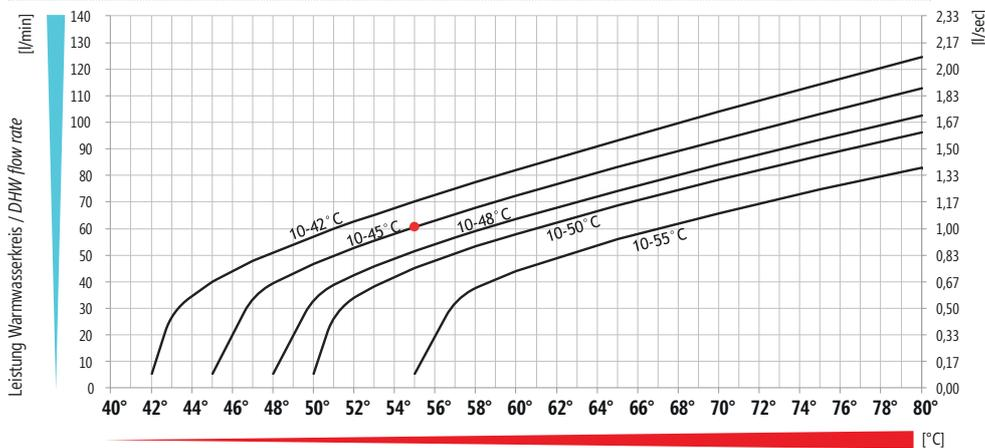
Ist die Vorlauftemperatur des Primärkreises um mindestens 5°C höher als die eingestellte Warmwassertemperatur, dann ist der korrekte Betrieb des Moduls garantiert.
